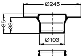
**Aufsatzelement mit Muffe**
